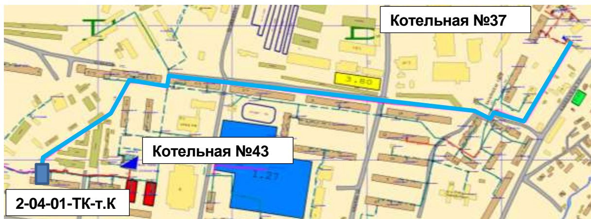
Рисунок 3.63 – Новый участок тепловой сети для переключения нагрузки котельной №37 на котельную №1, сценарий 3
