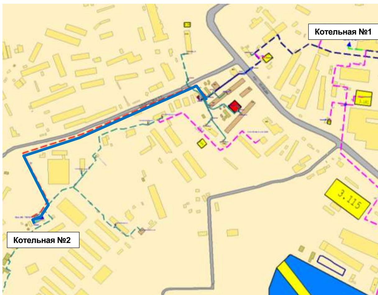
Рисунок 3.50 – Новый участок тепловой сети для переключения потребителей котельной №2 на котельную №1
