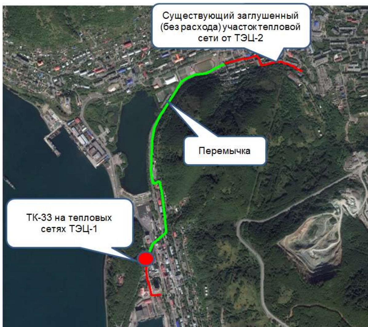
Рисунок 3.29 – Перемычка между тепловыми сетями ТЭЦ-1 и ТЭЦ-2
