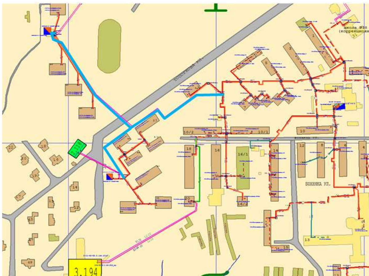
Рисунок 3.79 – Новые участки тепловых сетей для переключения тепловой нагрузки котельных ООО «Русский двор» на ТЭЦ-2
